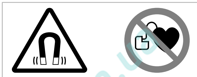
Рис. 21: Предупреждающие и запрещающие знаки на компрессоре с синхронным мотором с постоянными магнитами
